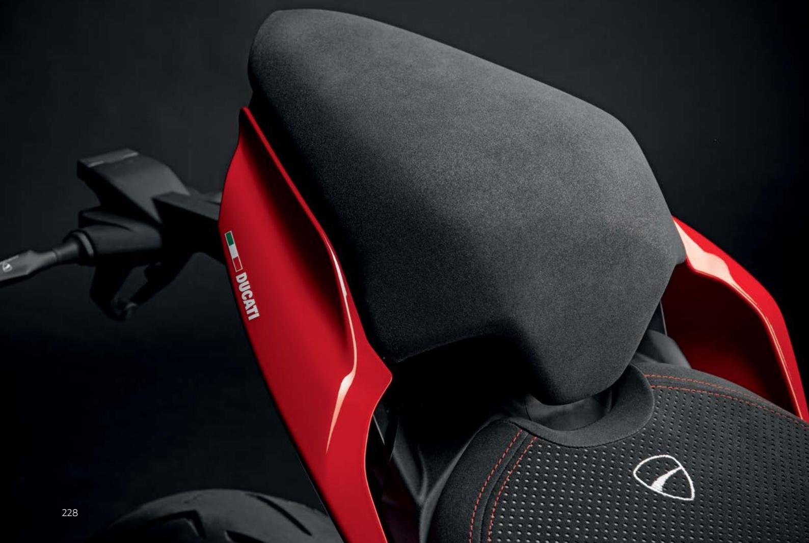
Sella bassa pilota. La minore altezza della seduta del pilota, ribassata di 20 mm, unita alla forma ottimizzata, facilita l'appoggio a terra, garantendo maggiore stabilità, sicurezza e il massimo comfort. Oltre a una posizione di guida ottimale, dona un look in pieno stile Ducati, grazie ai materiali di alta qualità e al design lineare.
